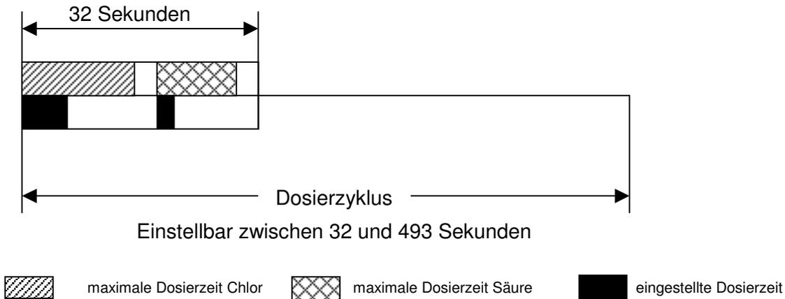
Die Dosierung erfolgt immer innerhalb der ersten 32 Sekunden eines Dosierzyklus. Dieser ist bei kontinuierlicher wie auch bei externer Ansteuerung zwischen 32 und 493 Sekunden wählbar. Grundsätzlich bleibt aber zwischen der Dosierung von Chlor und Säure eine Pause von mindestens 4 Sekunden – bei maximaler Dosierleistung. Eine gleichzeitige Dosierung von Chlor und Säure ist ausgeschlossen.
