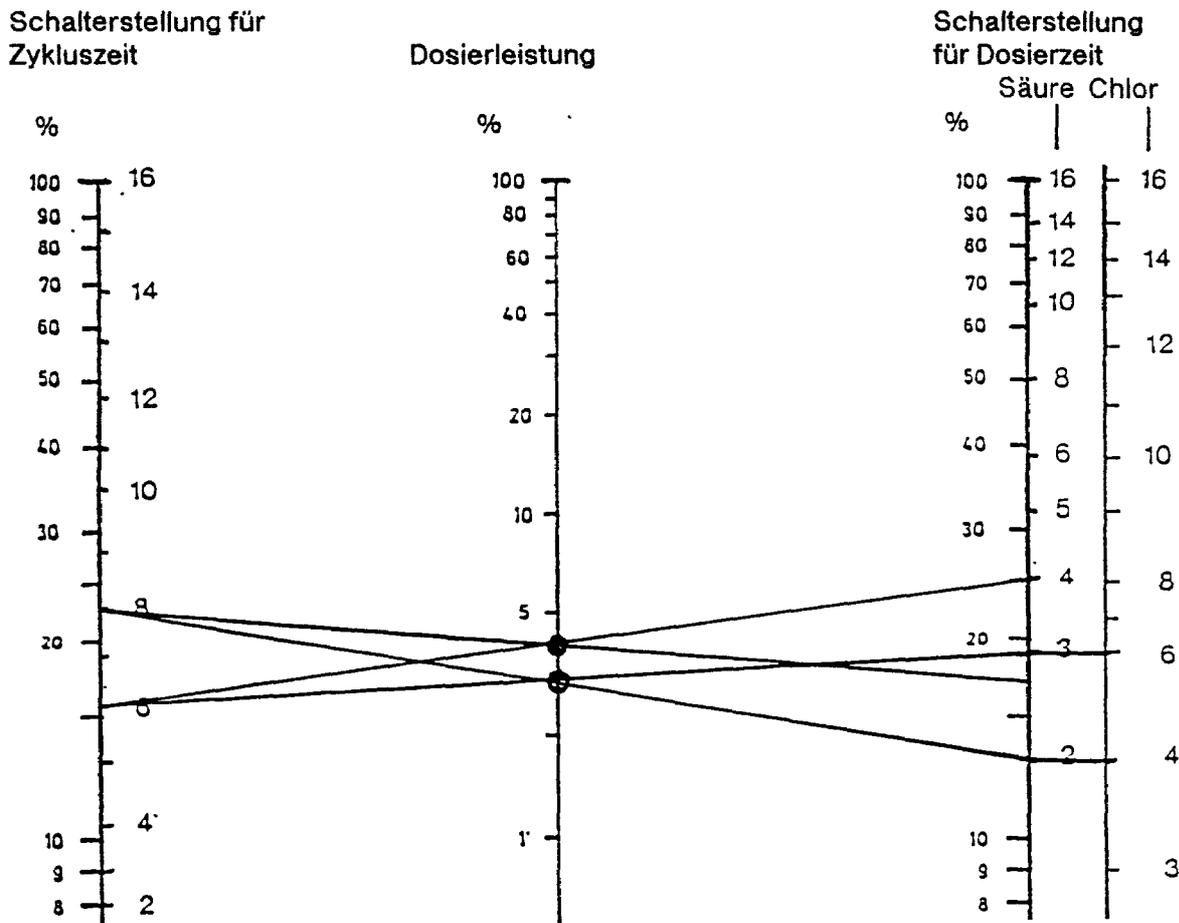
Tabelle für Zyklus- und Dosierzeiten: Die %-Zahlen beziehen sich auf die Maximale Dosierleistung:- Chlor ca.1 kg/h, Säure ca. 0,7 l/h
